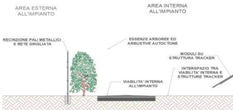
Figura 32: Sezione fascia di mitigazione perimetrale
