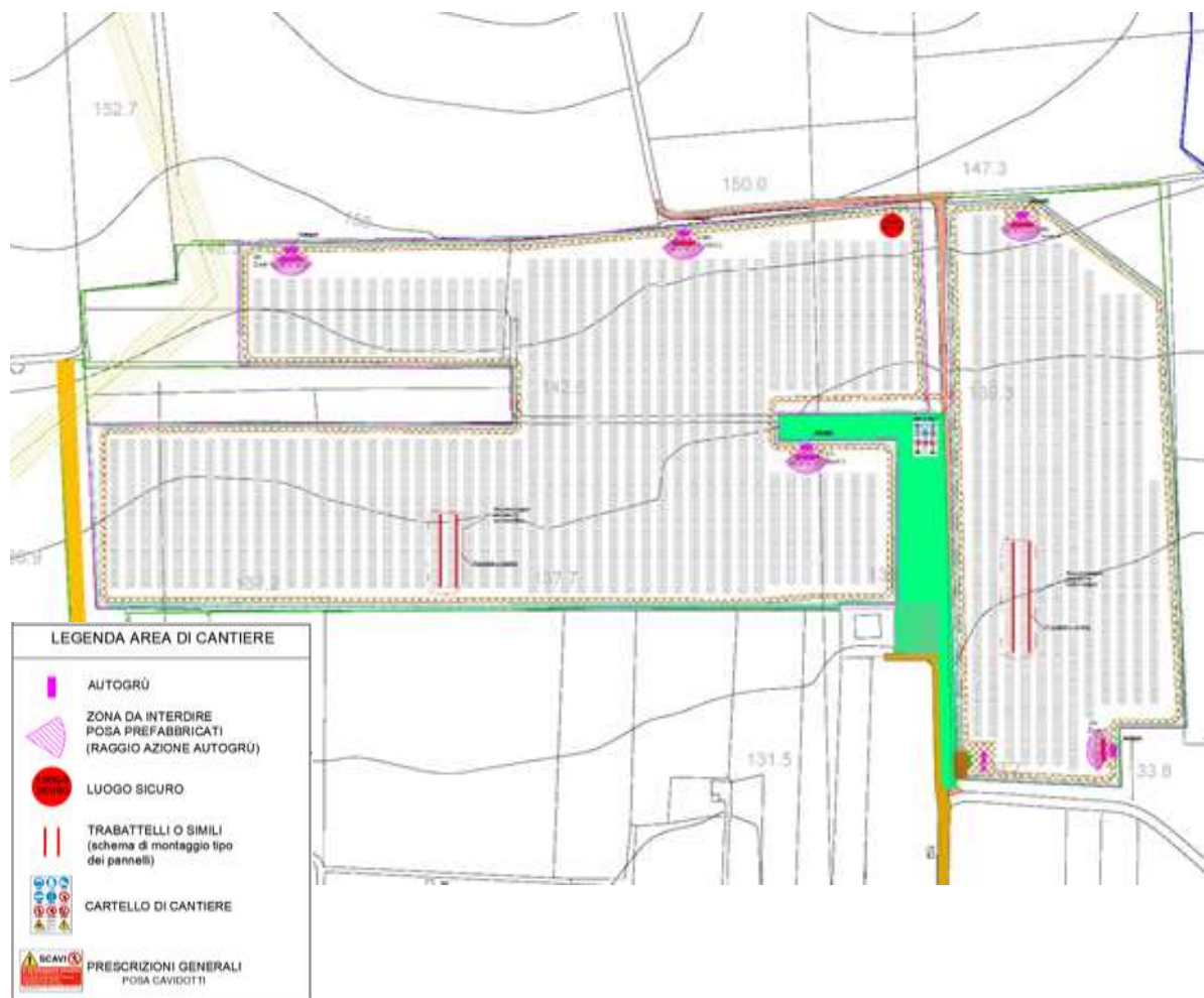
Figura 11: Layout di cantiere
