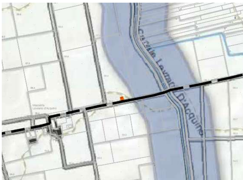
Figura 13 - Particolare tratto di cavidotto da realizzarsi sotto strada esistente e che intercetta il Canale Torrente d'Aiella Levranò d'Aquino con attraversamento in TOC Tavola 6.1.2
