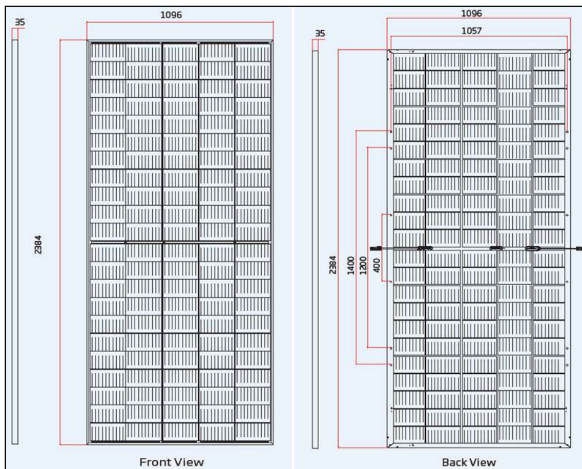
Figura 42 Dimensioni modulo "TSM-DEG19C.20"
