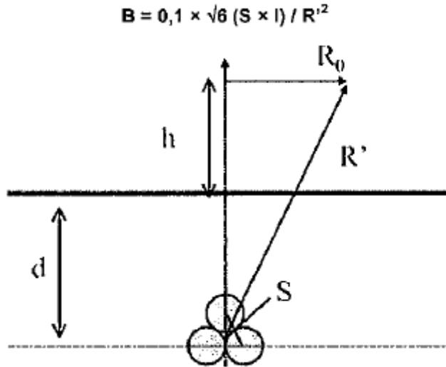
I cavi di tipo ARG7H1R sono intrecciati ad elica in modo da minimizzare l'induzione magnetica generata.
