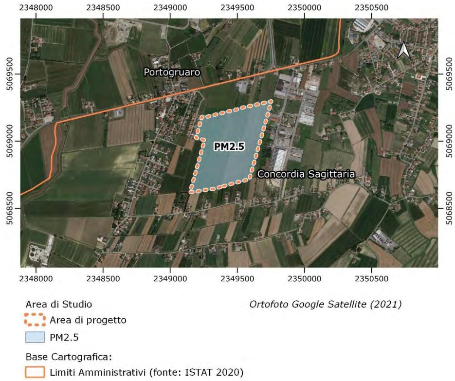
Figura 7-4 – Distribuzione delle ricadute di PM2.5 attorno alle aree di cantiere
