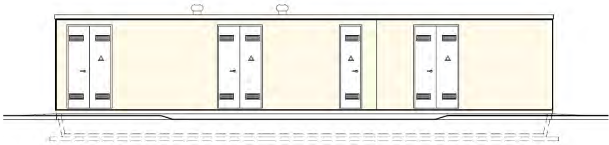
Figura 5-28 – Prospetto frontale della cabina MT/BT (Via Arrio)
