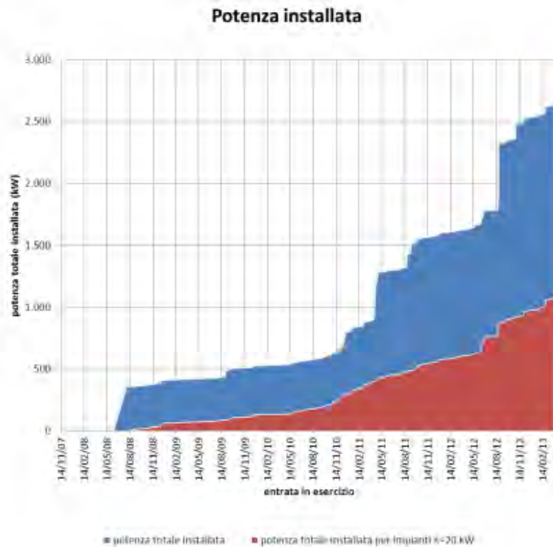
Figura 4-6 – Potenza totale installata di tutti gli impianti fotovoltaici (area blu) e potenza totale di quelli al di sotto dei 20 kW (area rossa), nel Comune di Concordia sagittaria dal 2007 (Elaborazione dati AtlaSole)
