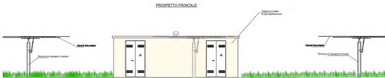
Figura 5-24 – Prospetto della cabina di campo
