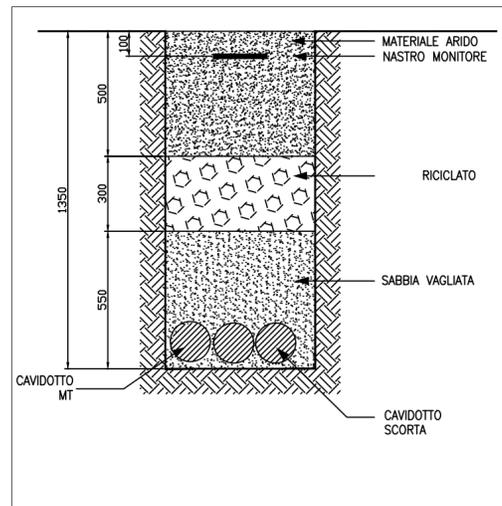
SEZIONE CAVIDOTTI MT - BT - CORDA DI TERRA
