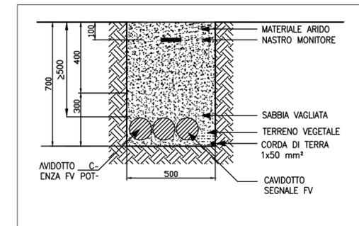
SEZIONE CAVIDOTTI BT E CORDA DI TERRA
