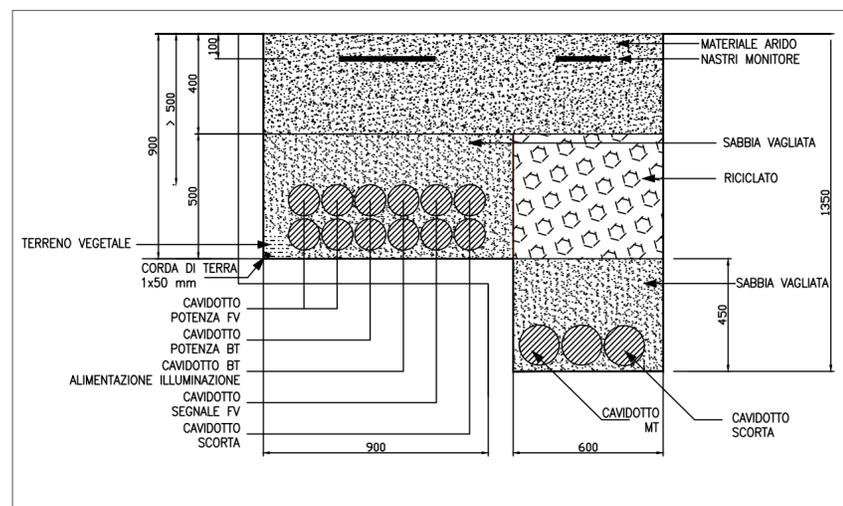
SEZIONE CAVIDOTTO BT IMPIANTO FV E CORDA DI TERRA
