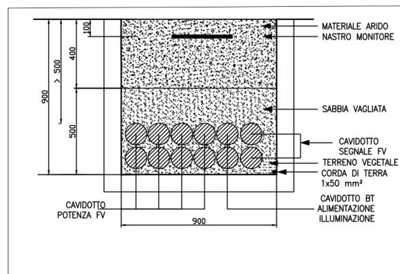
SEZIONE CAVIDOTTO BT IMPIANTO DI ILLUMINAZIONE E CORDA DI TERRA
