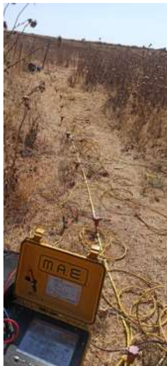
FOTO 3: postazione di energizzazione SS3
