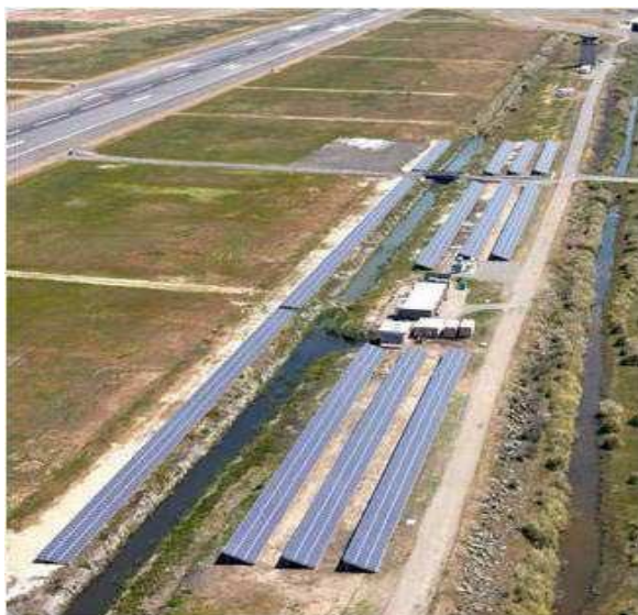
Figura 4: Esempi di impianti fotovoltaici in ambito aeroportuale. La disposizione dei moduli fotovoltaici in prossimità delle piste di atterraggio/decollo non rappresenta un rischio per la sicurezza.
