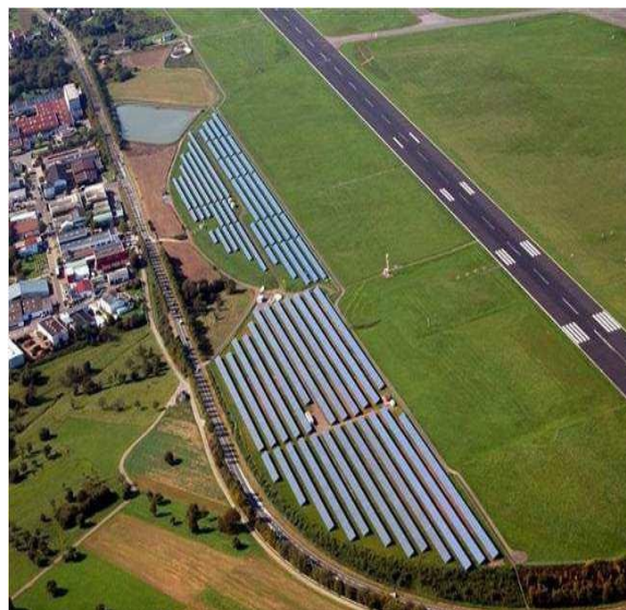
Figura 4: Esempi di impianti fotovoltaici in ambito aeroportuale. La disposizione dei moduli fotovoltaici in prossimità delle piste di atterraggio/decollo non rappresenta un rischio per la sicurezza.
