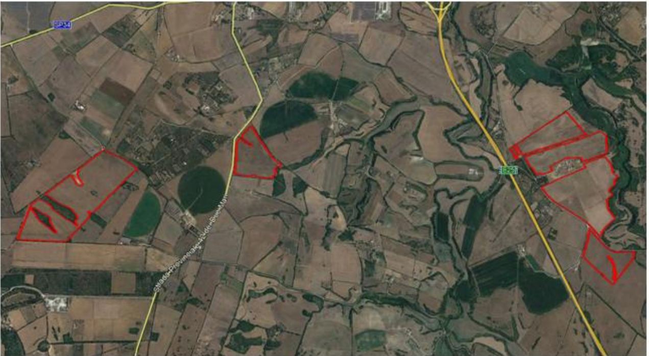
Inquadramento su Ortofoto In rosso sono indicate le aree recintate all'interno delle quali saranno installati i pannelli fotovoltaici
