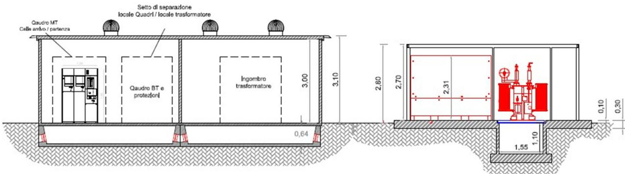
**Sezione trasversale Cabina di Campo e Shelter di conversione-trasformazione**
