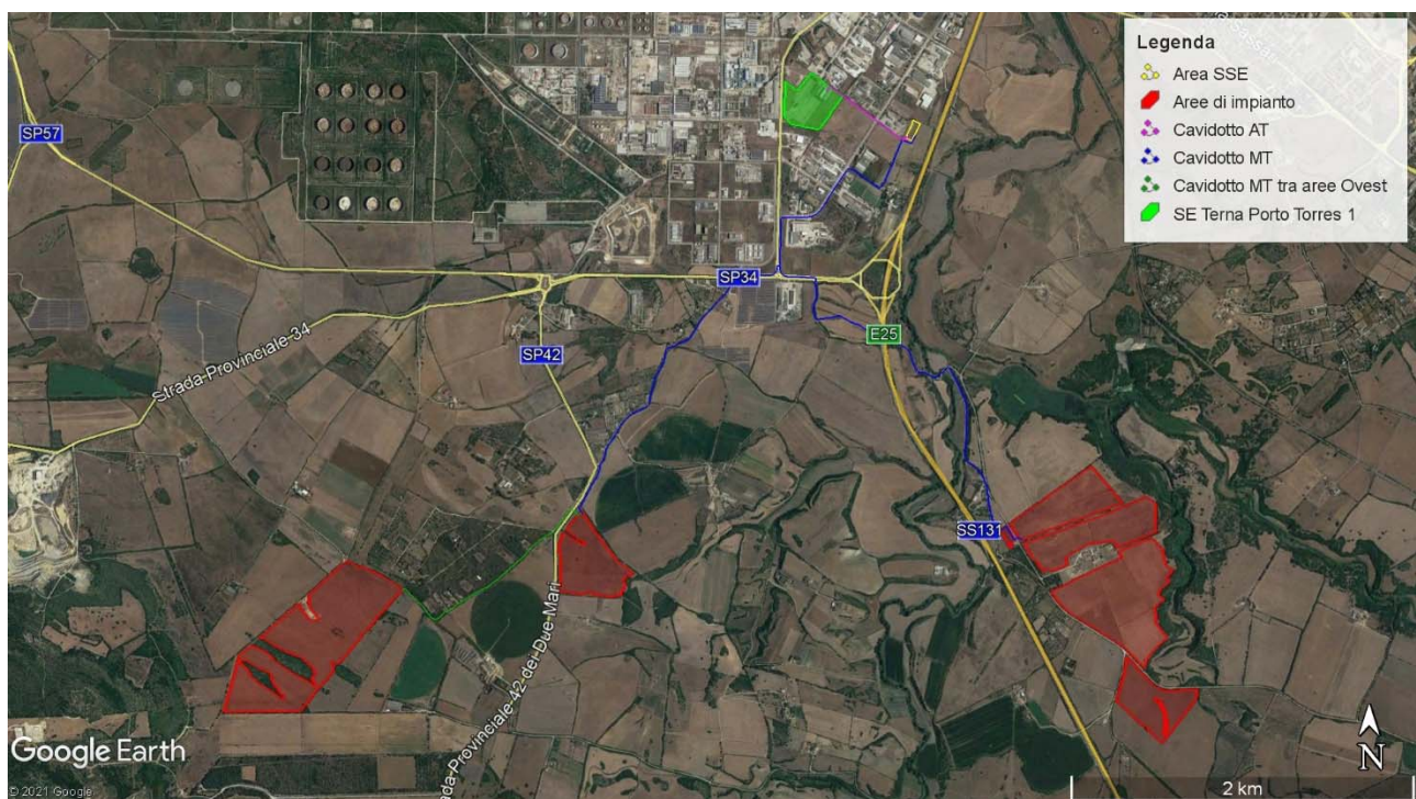
Inquadramento su Ortofoto – Area impianto (in rosso), e opere di connessione (in giallo la SSE Utente, in blu il cavidotto MT, in magenta il cavidotto AT che termina nella SE Terna di Porto Torres 1)
