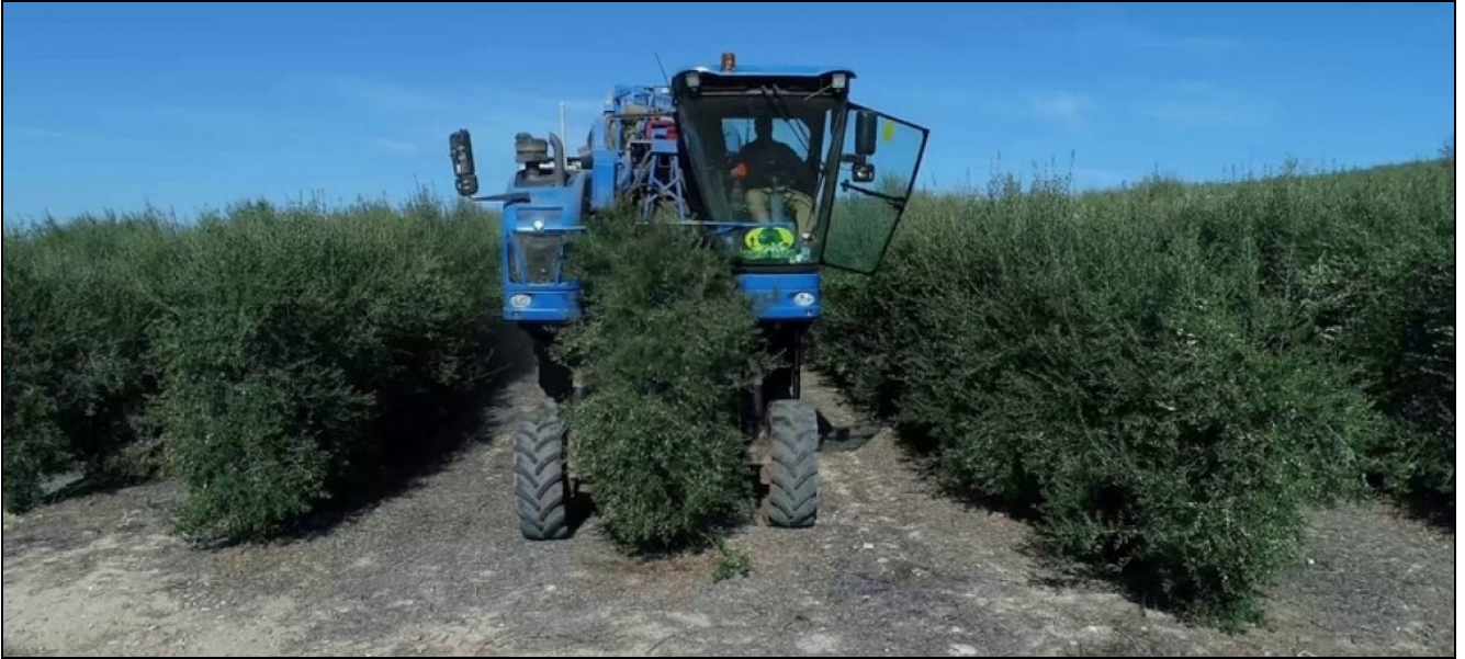
Esempio di raccolta meccanizzata con macchina scavallatrice
