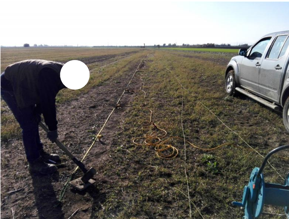
Energizzazione con mazza battente onde longitudinali (Onde P)
