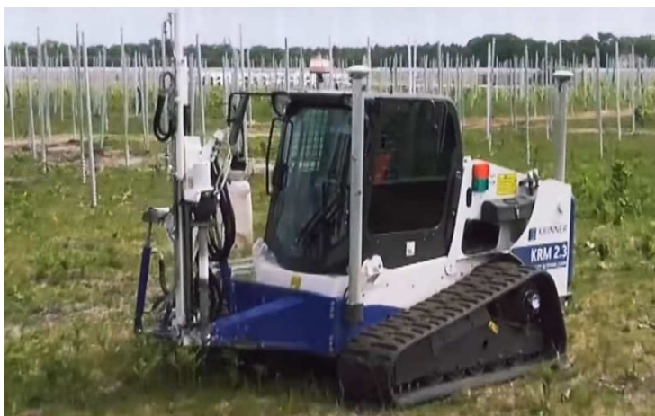
Fig. 29. Esempio di fissaggio delle strutture di supporto
