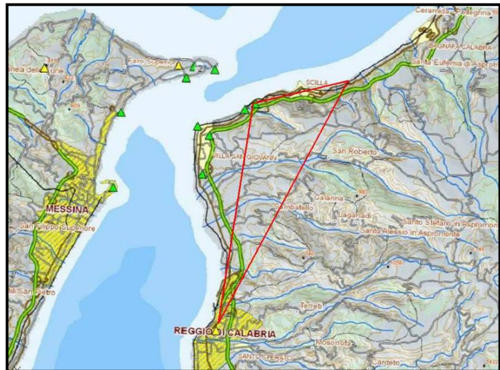
Figura 15. Triangolazione usata per il caposaldo di Favazzina, a partire dai due capisaldi IGM di Reggio Calabria e Scilla-Porticello.
