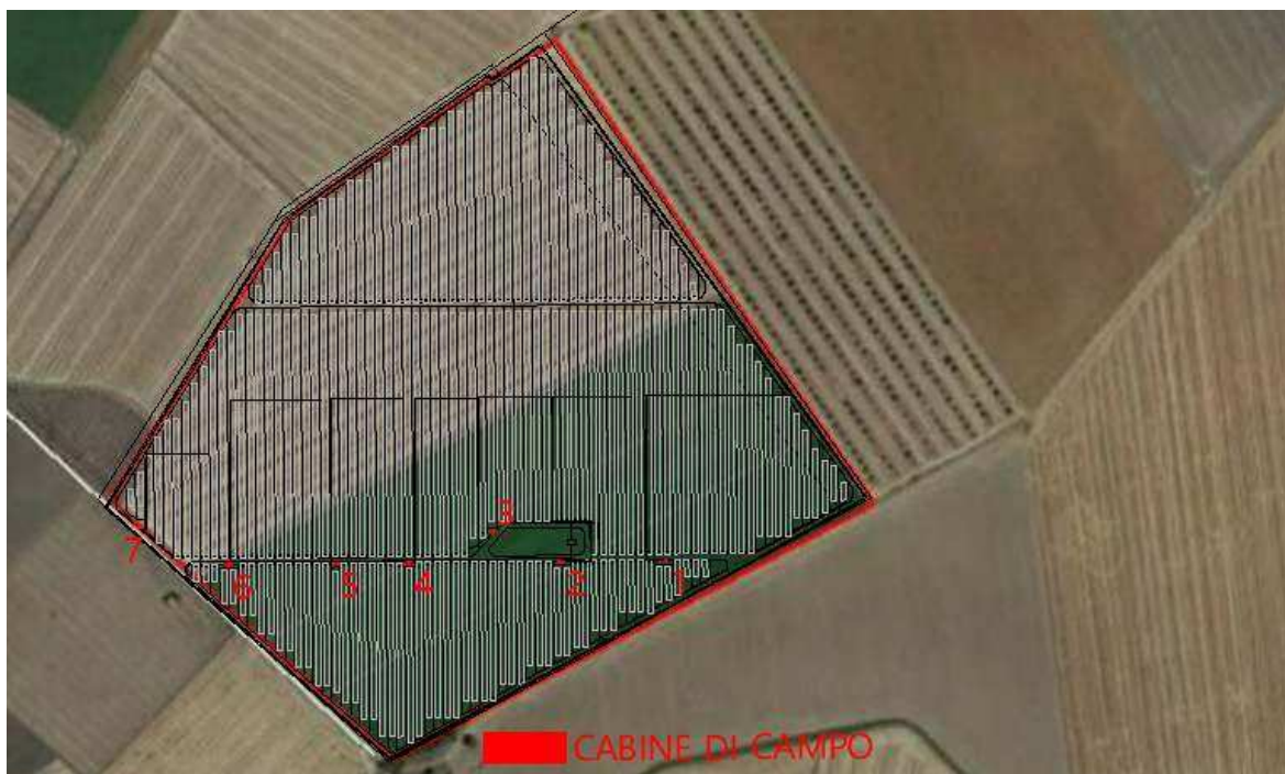
Fig. 3_Localizzazione cabine di campo
