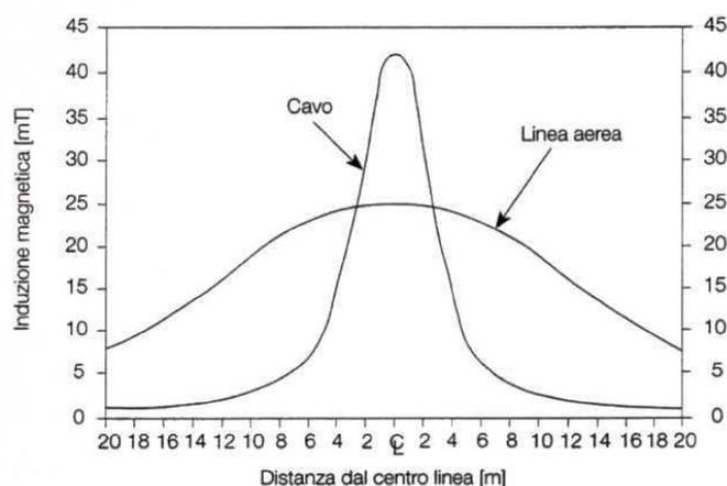
*Fig. 9. Induzione magnetica per linea aerea e cavo interrato*
