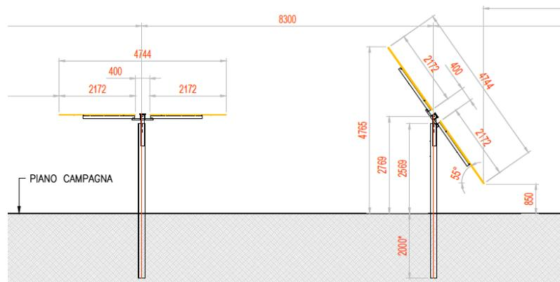
Figura 4.4: Particolare strutture di sostegno moduli
