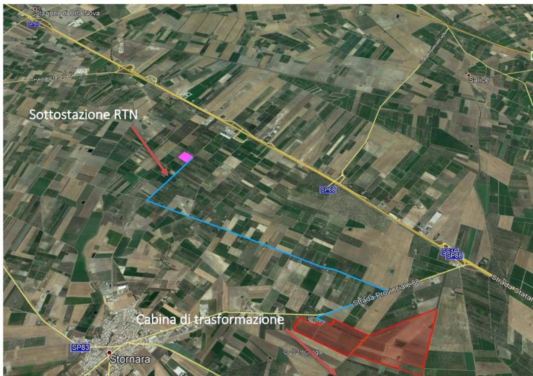
Figura 4.9. percorso di connessione dalla cabina di trasformazione alla Sottostazione AT di Stornara
