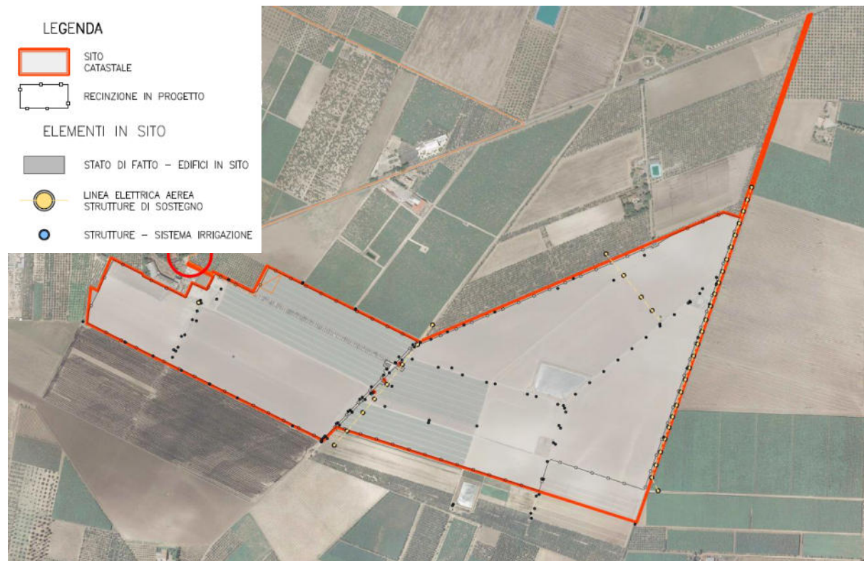
Figura 2.1: Individuazione delle Interferenze nell'Area di Installazione dell'impianto
