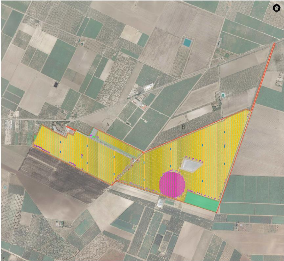
Figura 2.7: Layout di progetto area impianto FV
