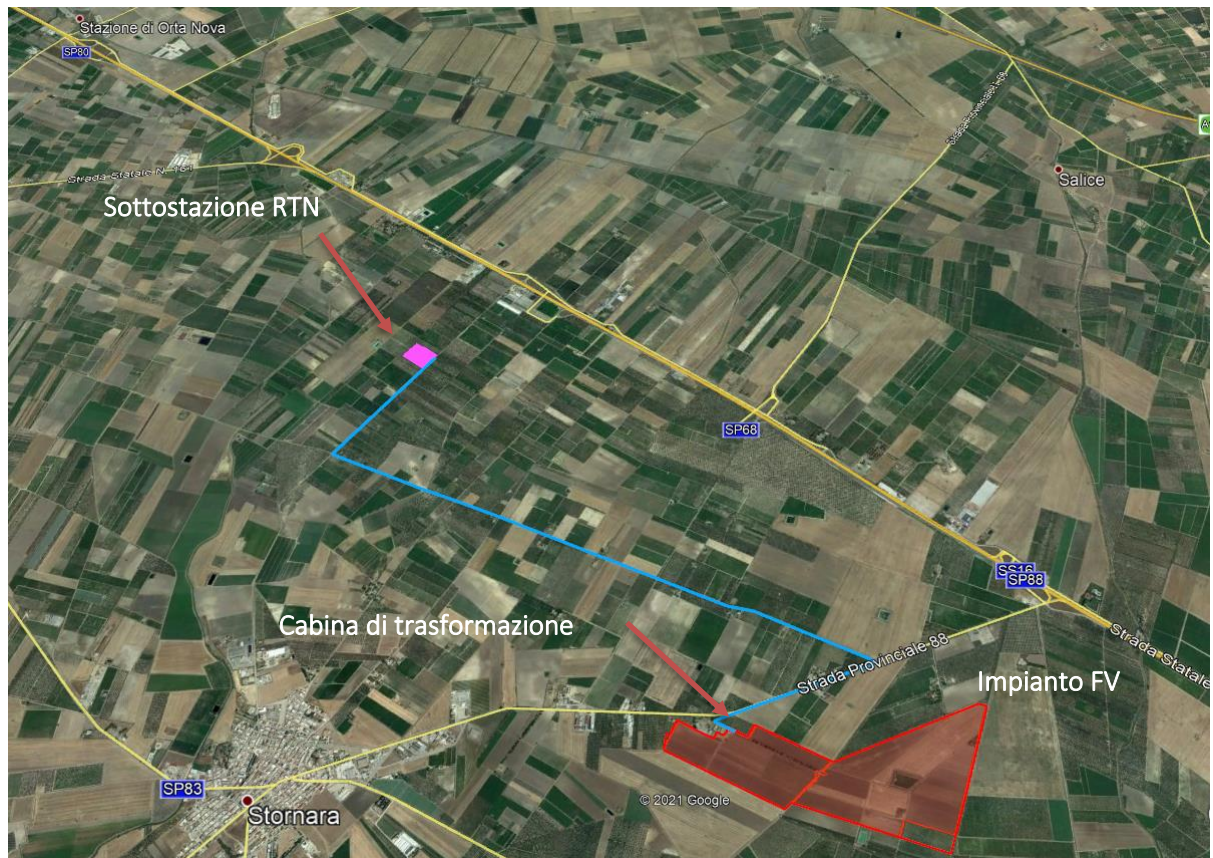
Figura 2.42. percorso di connessione dalla cabina di trasformazione alla Sottostazione AT di Stornara
