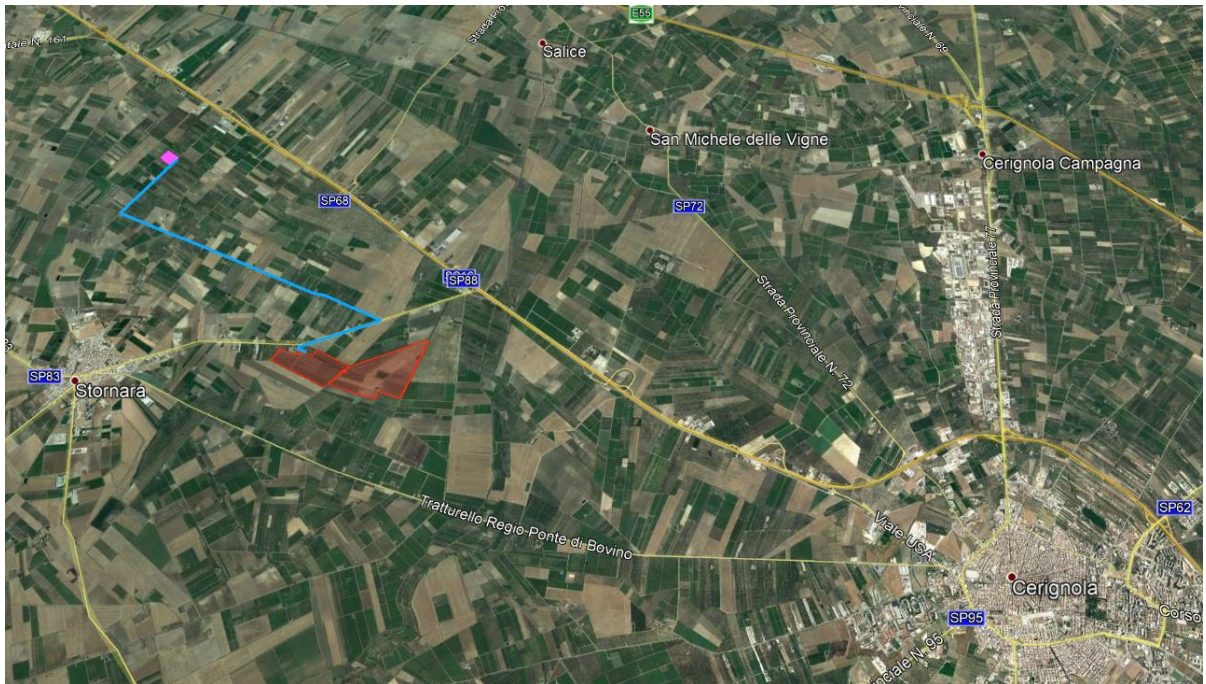
Figura 2.2: Localizzazione intervento (rosso-area parco; ciano-cavidotto; magenta-SSE)
