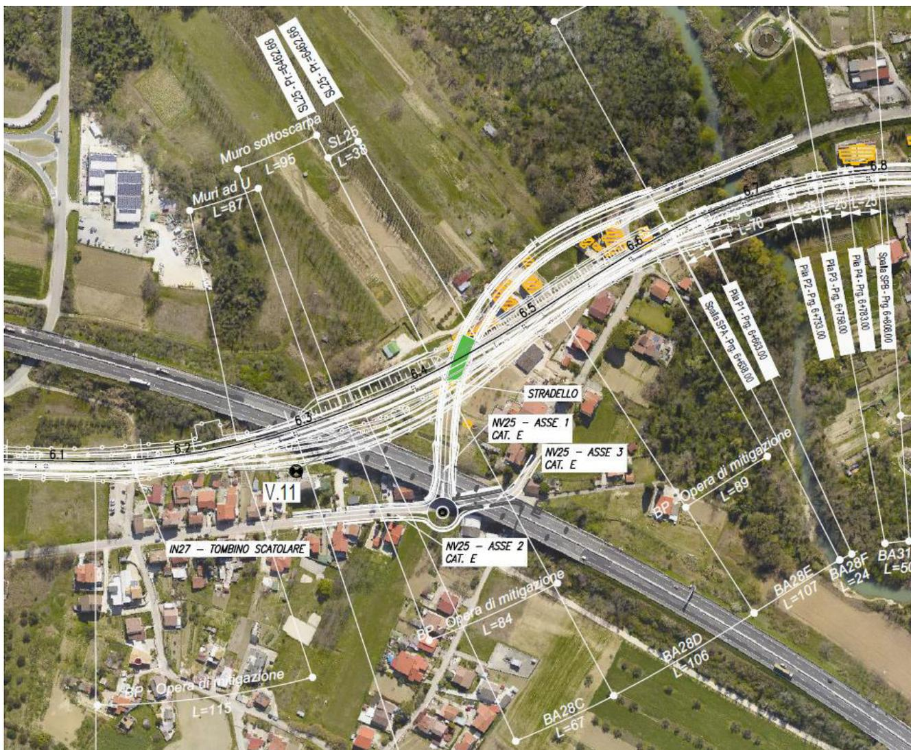
Fig. 26 – Sottoattraversamento A25 con deviata provvisoria della L.S.
