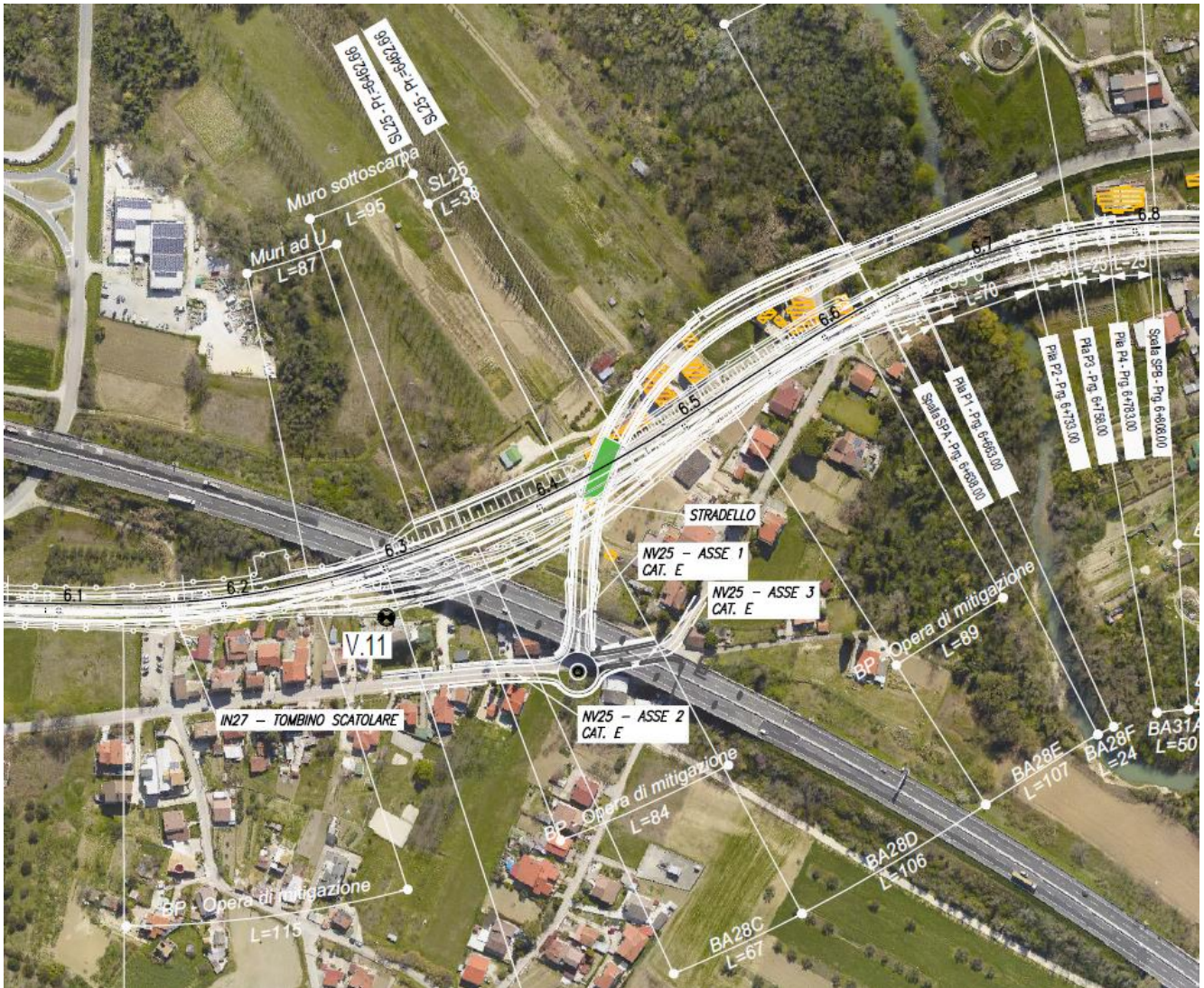
Fig. 6 – sottoattraversamento A25 con deviata provvisoria della L.S.
