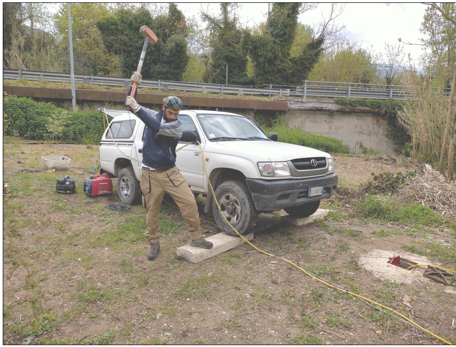
Fase di acquisizione dati - Prova M.A.S.W./Re.Mi. SM_MASW07
