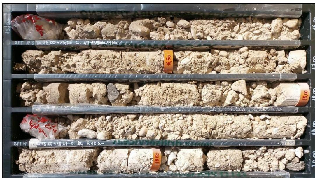
Figura 6.16 Foto del sondaggio SM\_S2, cassetta 4, in cui si osservano ghiaie eterometriche immerse in matrice sabbioso-limosa da scarsa ad abbondante, di colore avana, con intercalazione di livelli limoso-sabbiosi; tali depositi appartengono alla *litofacies* ghiaioso-sabbiosa (ALT1a)
