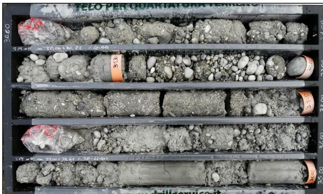
Figura 6.14 Foto del sondaggio SM\_12bis, cassetta 7, in cui si osservano conglomerati cementati e ghiaie molto addensate immerse in matrice sabbioso-limoso-argillosa; da -34.4 m a -35.0 m di profondità dal p.c. si nota l'intercalazione di un orizzonte argilloso-limoso debolmente sabbioso, da mediamente a molto consistente
