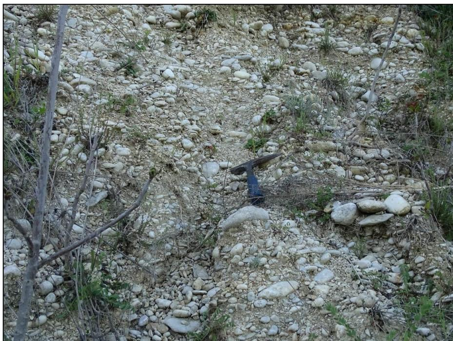
**Figura 6.15** Scarpata antropica in prossimità di Loc. Piano della Fara (coord.: 4684410.0 N, 2440581.0 E) che mette alla luce ghiaie immerse in matrice sabbioso-limosa avana e nocciola; i clasti delle ghiaie sono eterometrici, generalmente arrotondati o subarrotondati, di origine prevalentemente calcarea e subordinatamente silicea, talora disposti con leggera embricatura verso valle (parte destra della foto)
