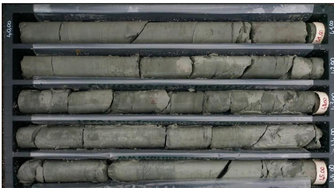
**Figura 6.25** Foto del sondaggio SM\_S3, cassetta 9, in cui si osservano argille-marnose consistenti riconducibili alla *litofacies* argilloso-marnosa (CEN); si nota la presenza di fratturazione particolarmente intensa a profondità dal p.c. comprese tra -41.4 m e -43.10 m
