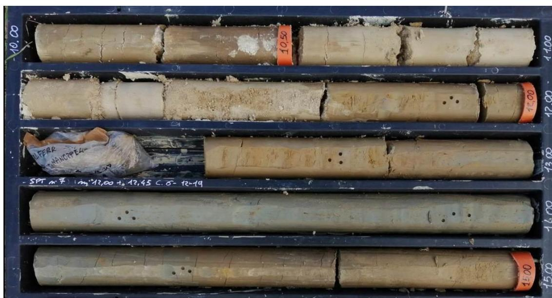
Figura 6.20 Foto del sondaggio SM\_S9, cassetta 3, da -11.7 a -15.0 m di profondità dal p.c. sono visibili argille limose debolmente marnose, consistenti, di colore variabile dal grigio al nocciola, con sparsi frammenti calcarei generalmente millimetrici; tali depositi sono riferibili alla *litofacies* argilloso-limosa (ALT4a)
