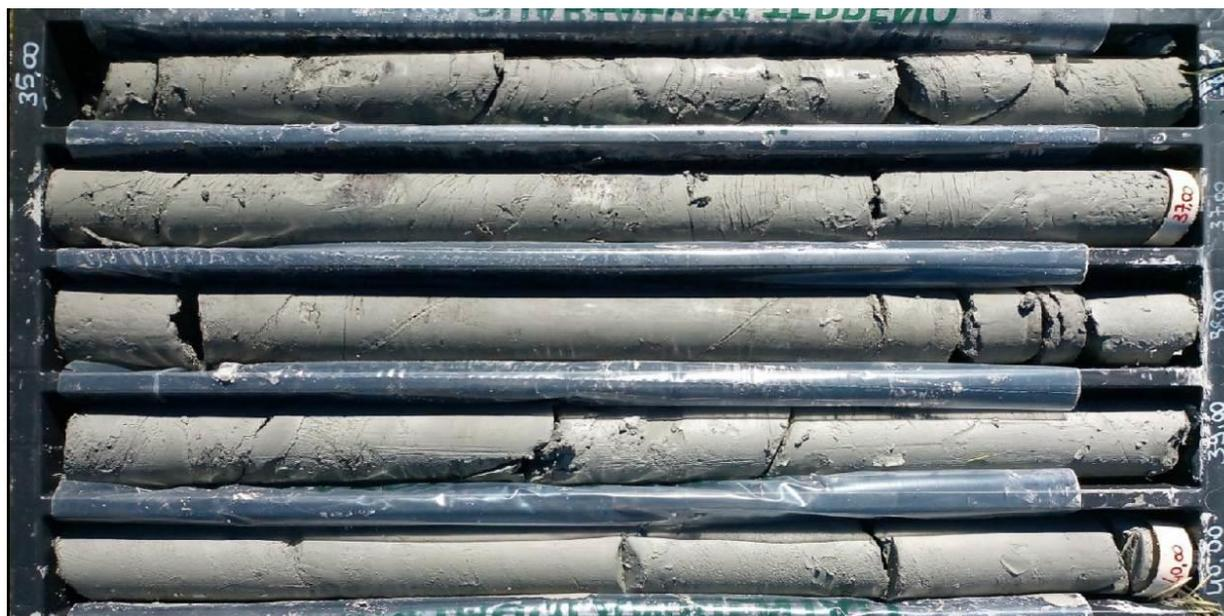
**Figura 6.9** Foto del sondaggio SM\_S7, cassetta 3, in cui si osservano argille-marnose consistenti riconducibili alla *litofacies* argilloso-marnosa (CEN); si nota la presenza di fratturazione ad alto angolo con spaziatura di 40-50 cm
