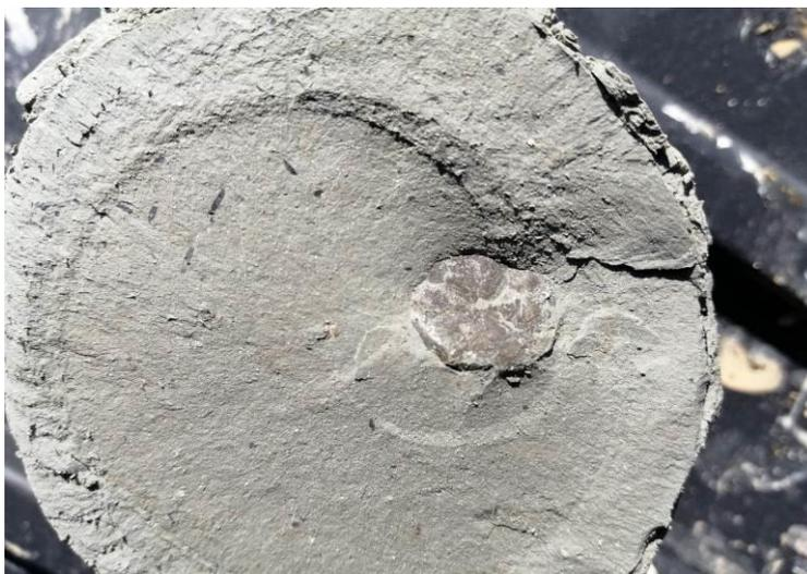
**Figura 6.10** Foto del sondaggio SM\_S1, cassetta 7, in cui si osservano limi argilloso-marnosi consistenti riconducibili alla *litofacies* argilloso-marnosa (CEN); si nota la presenza di resti e frammenti di echinodermi
