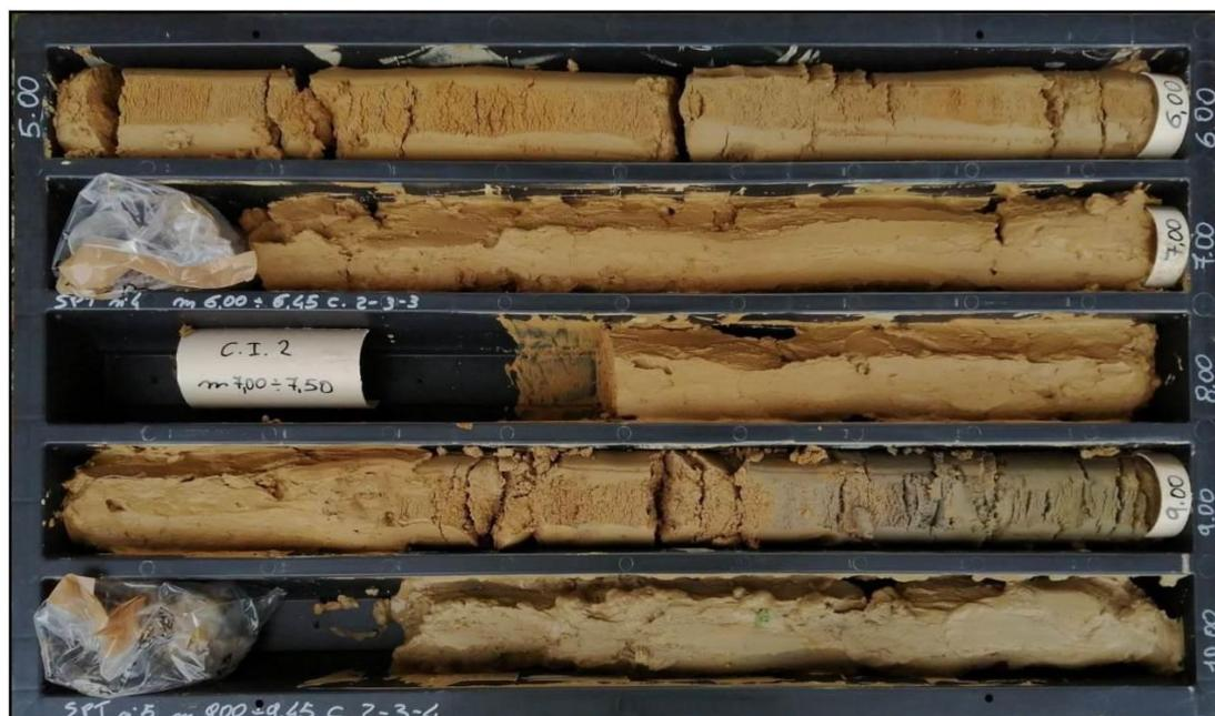
Figura 6.17 Foto del sondaggio SM\_S6, cassetta 2, in cui sono visibili sabbie, sabbie limose e limi sabbiosi di colore marrone e giallastro, con sparsi frammenti calcarei generalmente millimetrici; tali depositi sono riferibili alla *litofacies* sabbioso-limoso (ALT2a)
