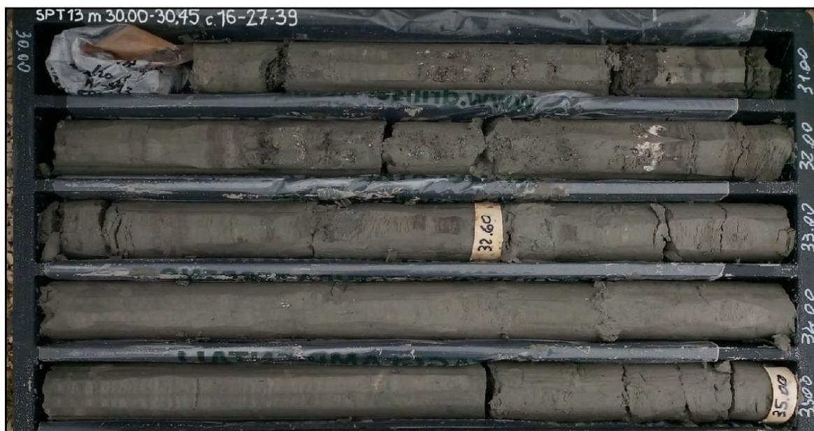
Figura 6.11 Foto del sondaggio SM\_25, cassetta 7, in cui si osservano argille limose e argille-marnose, da mediamente a molto consistenti, riferibili della *litofacies* argilloso-limosa (FMTa); da -30 m a -32 m di profondità dal p.c. sono presenti abbondanti frammenti di molluschi
