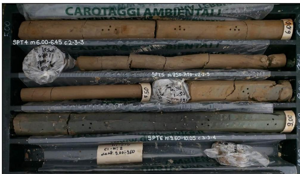
Figura 6.19 Foto del sondaggio SM\_S25, cassetta 2, in cui sono visibili limi argillosi e argilloso-sabbiosi di colore marrone e grigiastro, con sparsi frammenti calcarei generalmente inferiori al centimetro; tali depositi sono riferibili alla *litofacies* limoso-argillosa (ALT3a)
