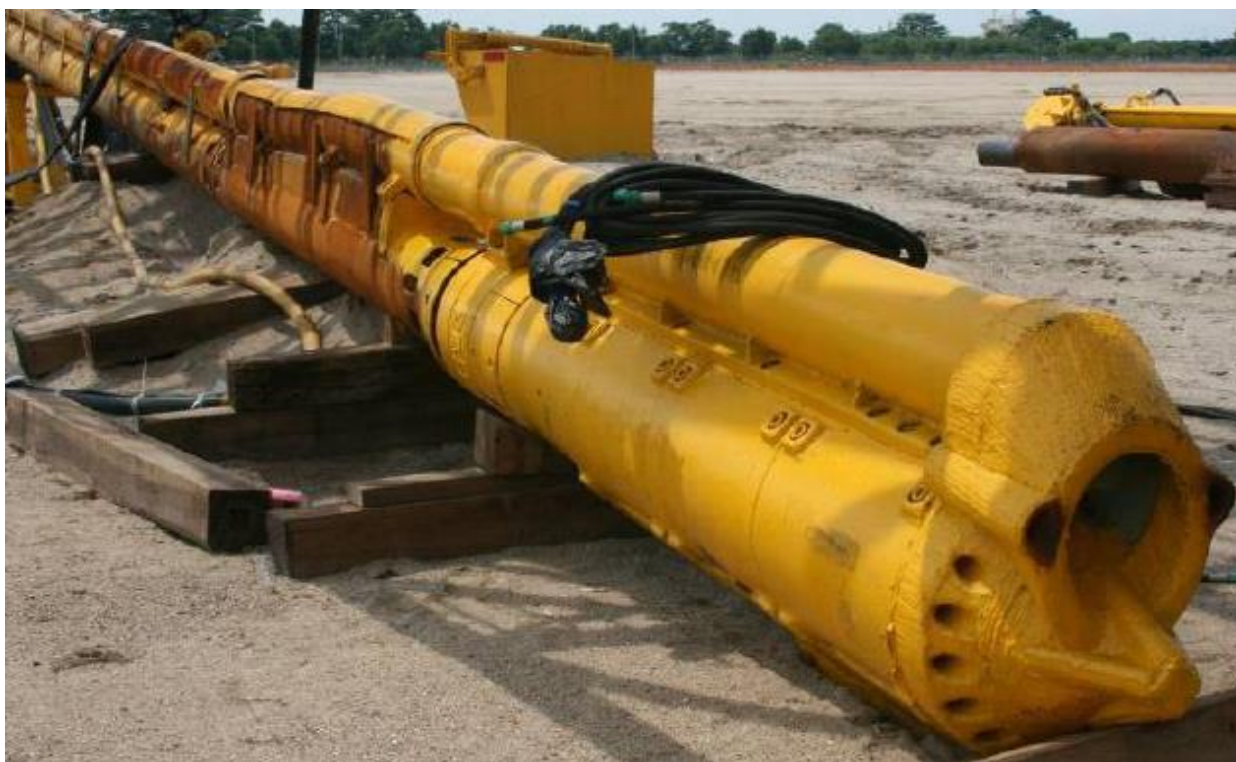
F 13. Dettaglio della punta dell'utensile e tubo di consegna ghiaia
