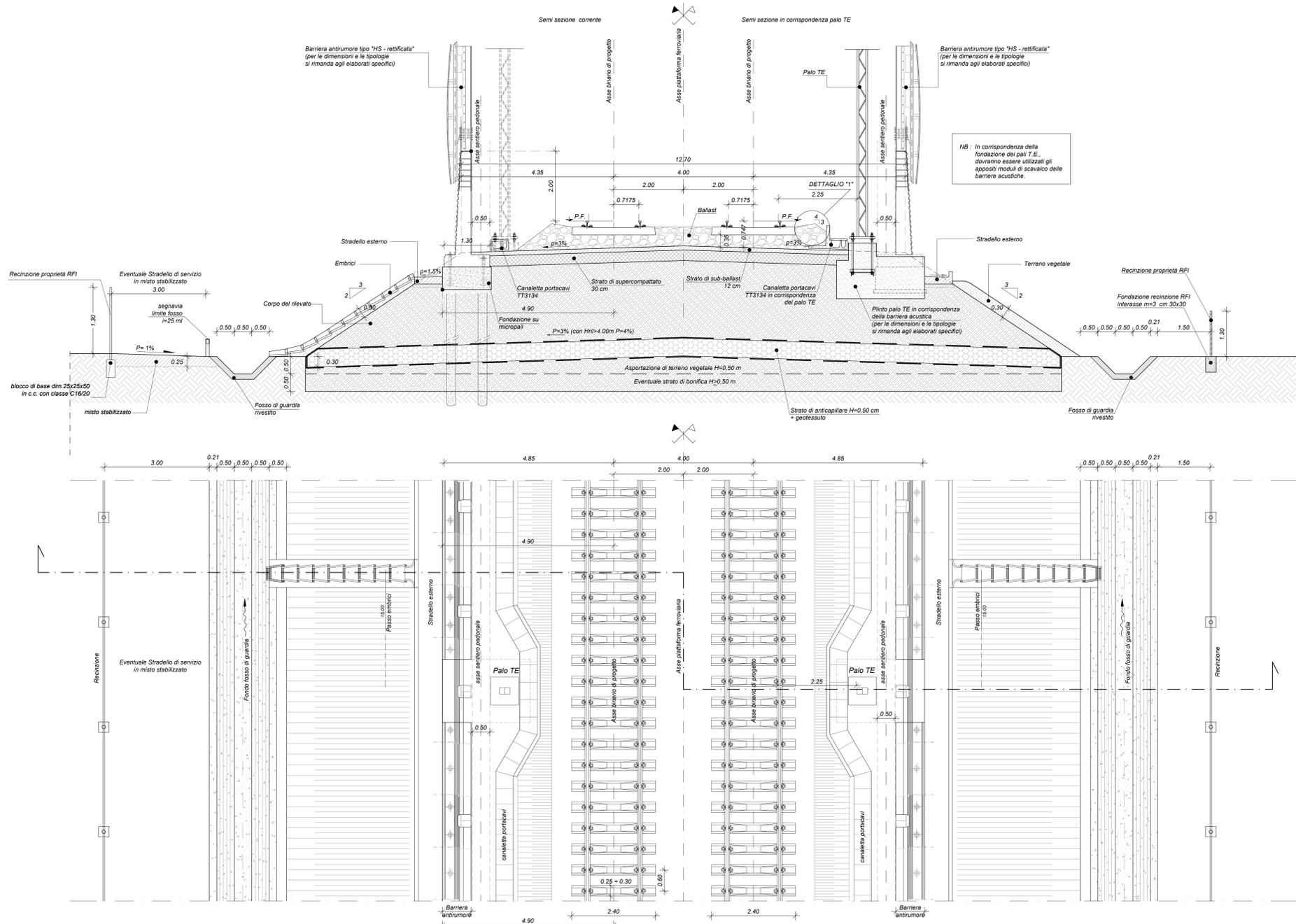
Sezione tipo a doppio binario in rilevato con Barriera antirumore
