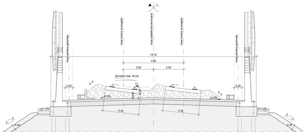
Dettaglio "1" - Andamento traversa in rettilo ed in curva
