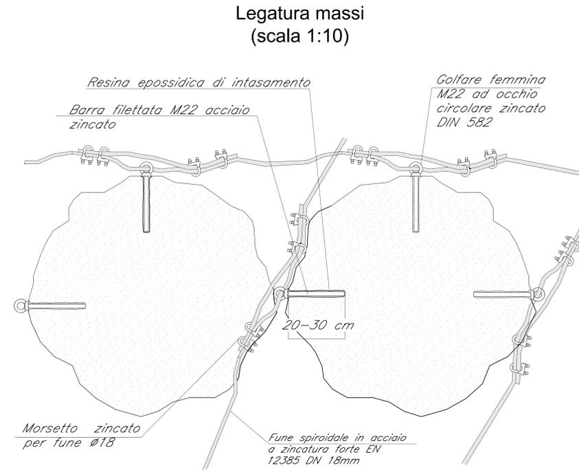
N.B. Le congiunzioni mediante morsetti devono essere conformi alla norma UNI EN 13411
