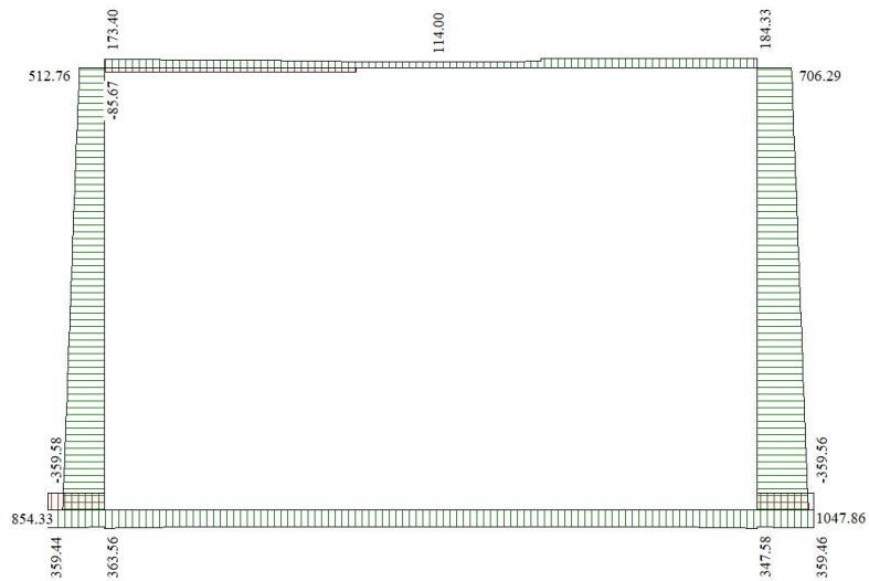
Figura 15 Inviluppo SLU/SLV: sforzo normale
