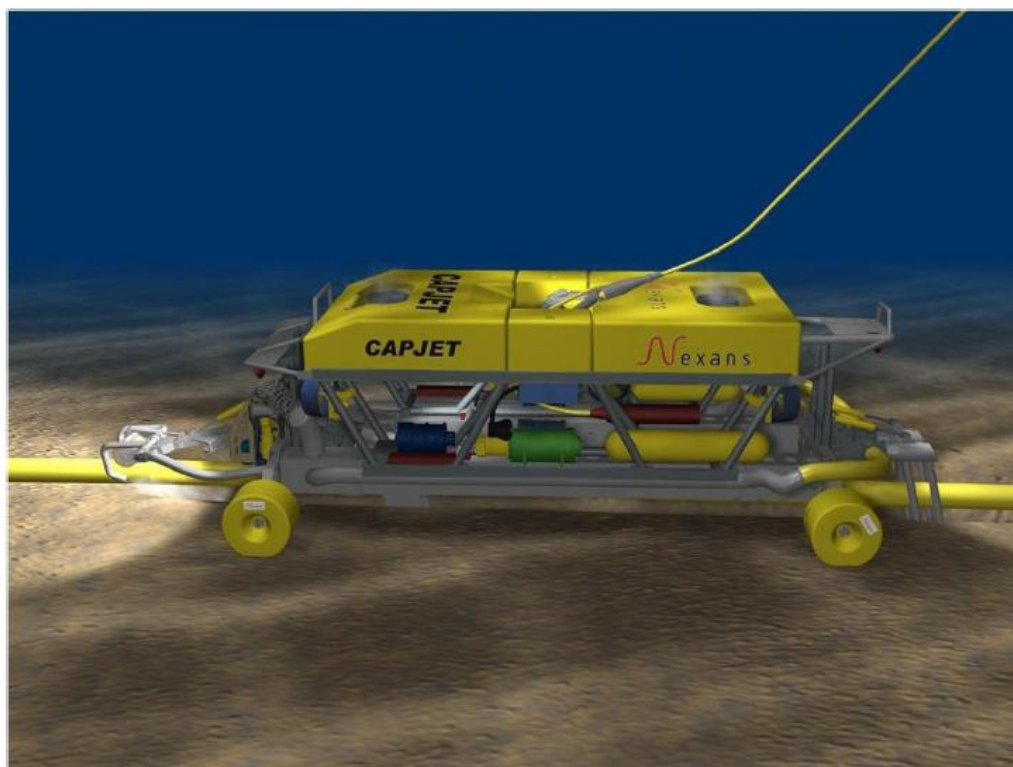
Figura 8.12 Macchina a getti d'acqua per l'interramento dei cavi
