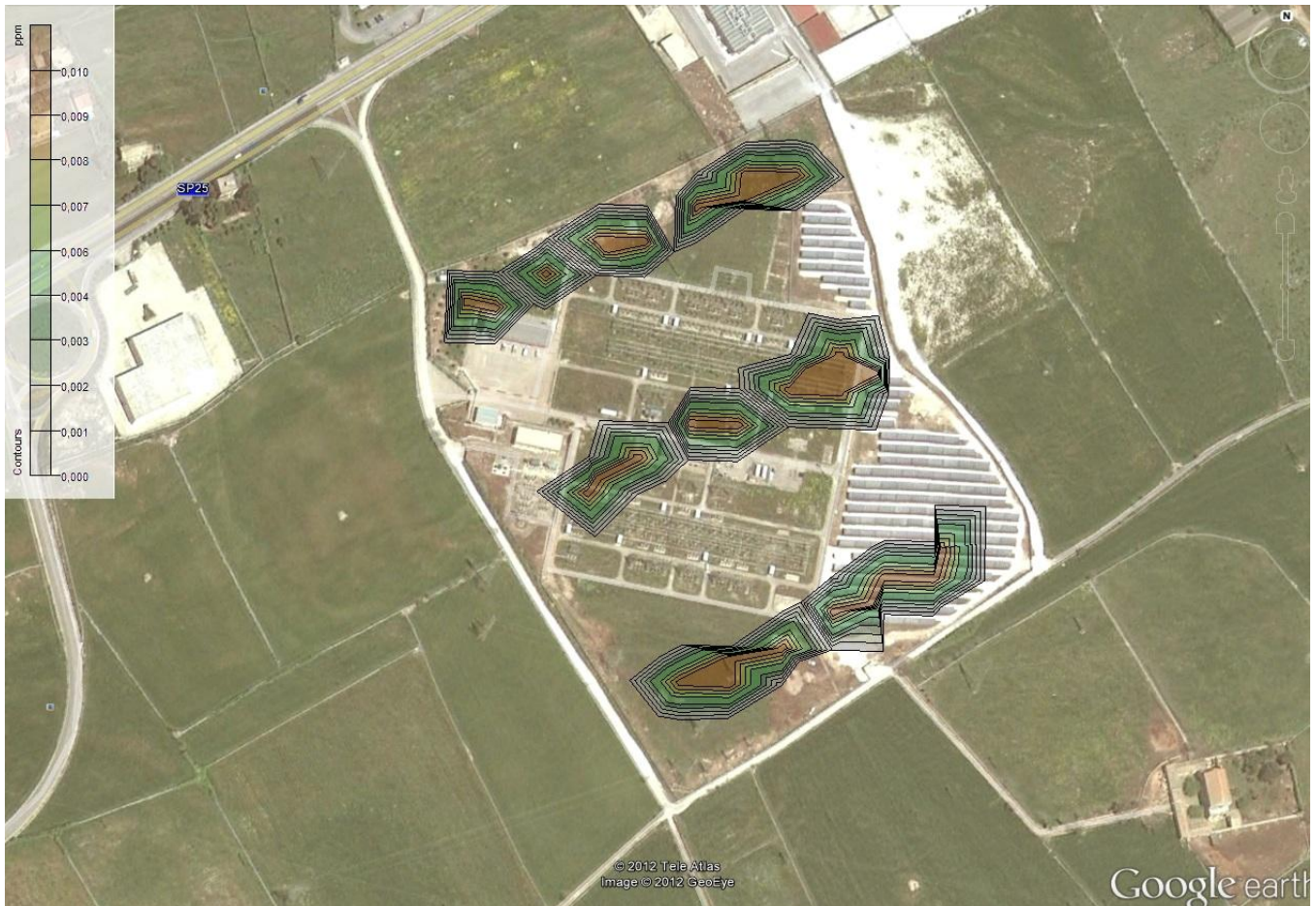
Figura 21.11 Cantiere Stazione - Curve di isoconcentrazione massime orarie per il NO2
