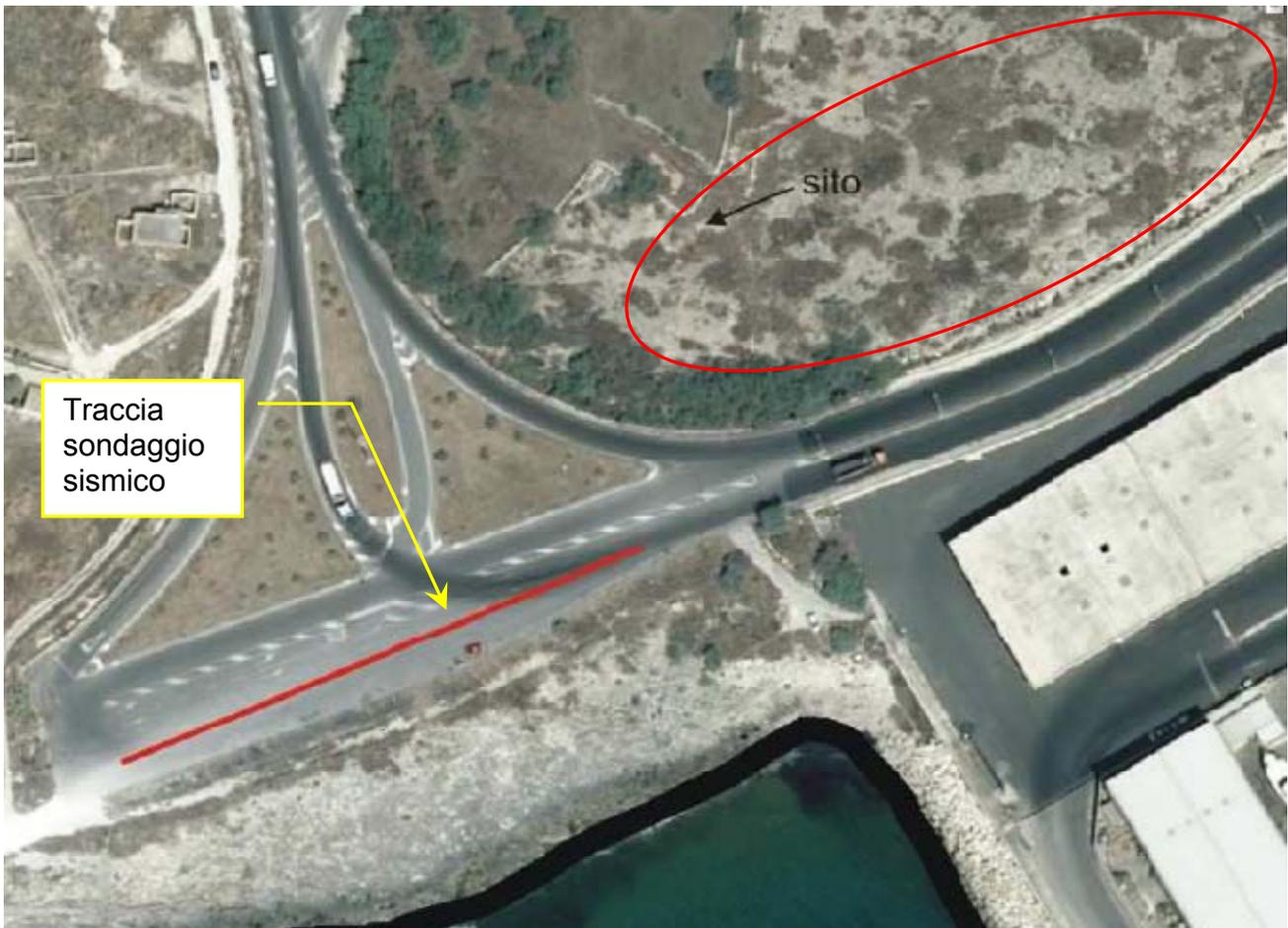
L'analisi dei dati rilevati ha consentito la determinazione della velocità equivalente delle onde di taglio  $V_{s,30}$ , a partire dalla quota del piano fondazione, da questa risulta una categoria di sottosuolo inquadrabile nell'ambito della classe A (vedi relazione sull'indagine sismica allegata).
