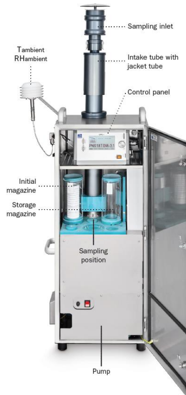
FIGURA 6 CAMPIONATORE SEQUENZIALE AUTOMATICO.
