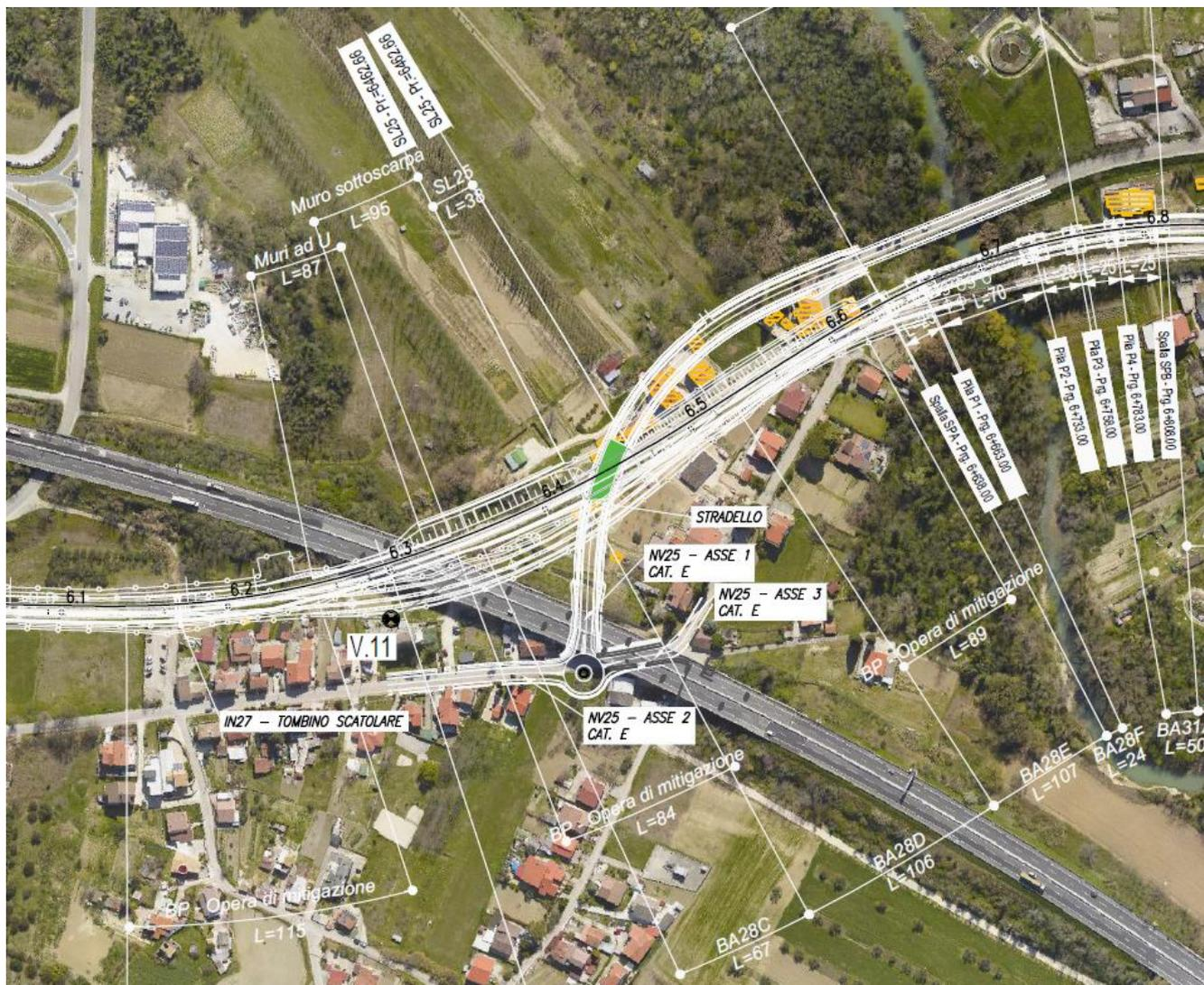
Figura 4-6 sottoattraversamento A25 con deviata provvisoria della L.S.
