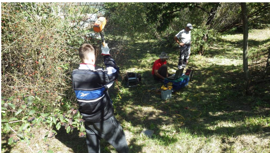
Fig. 16 - Stendimento sismico ed energizzazione per registrazione MASW / Re.Mi..
