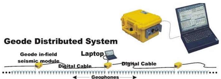
Fig. 27 – Fase di registrazione della sismica a rifrazione.
