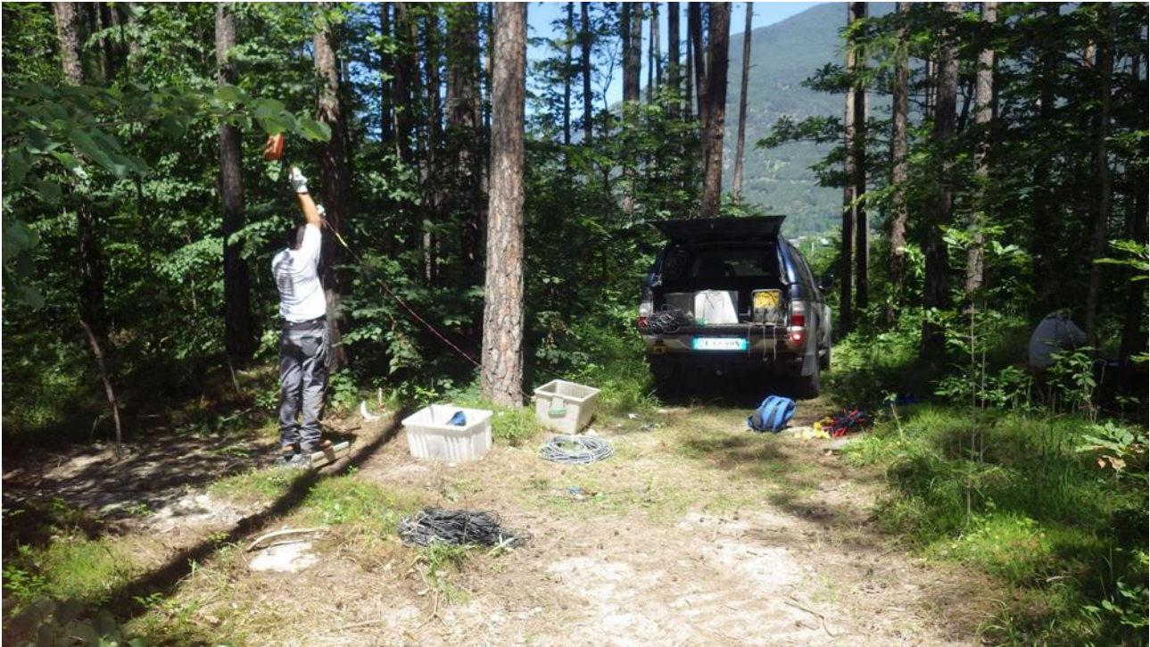
Fig. 27 – Fase di registrazione della sismica a rifrazione.
