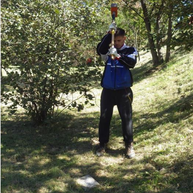
Fig. 17 – Particolare energizzazione Prova MASW.
