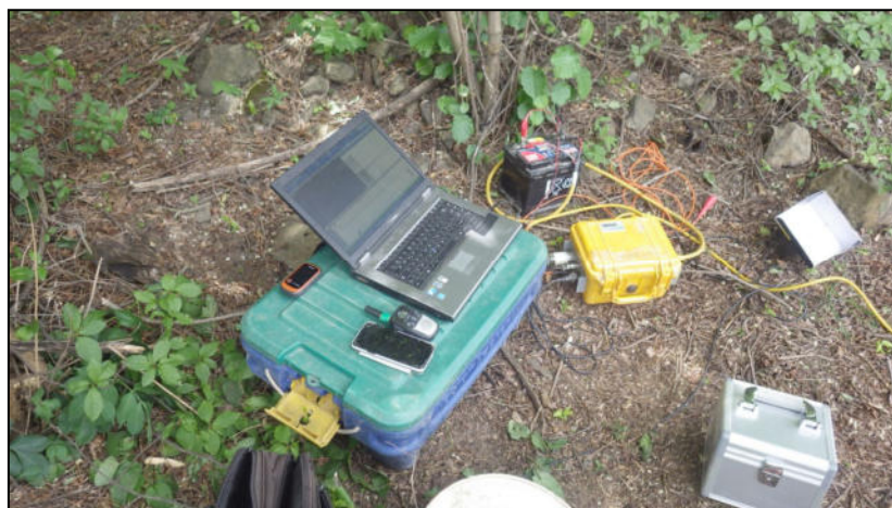
Fig. 6 - Stendimento sismico per registrazione MASW / Re.Mi..
