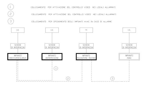
Trascorso un prefissato tempo (configurabile) senza che sia stato disattivato l'allarme proveniente dal sistema antintrusione o rivelazione incendi, la segnalazione di allarme stessa sarà trasmessa al sistema di supervisione.
