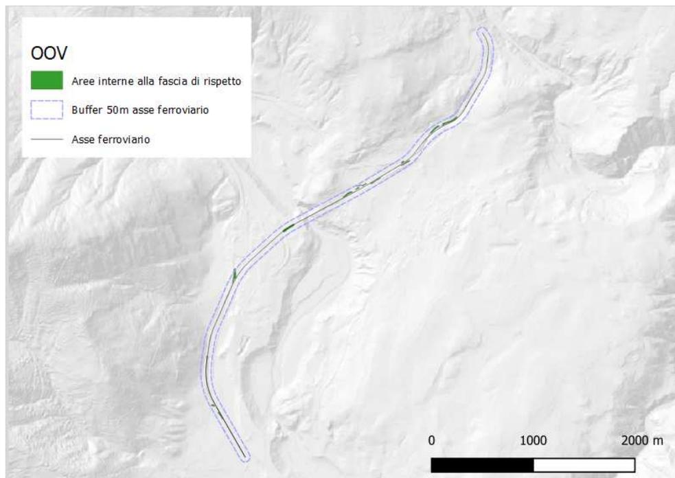
**Figura 4-1** Panoramica delle OOV per la tratta Varna – Naz-Sciaves. In verde sono riportate le aree destinate a piantumazione di arbusti (tipologia A), all'interno del buffer di 50m dall'asse ferroviario.
