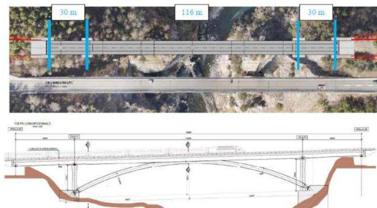
L'altezza delle travi principali d'impalcato, realizzato in sezione mista acciaio-calcestruzzo, è pari a 2,38 m e disposte ad un interasse costante di 3,60 m, mentre la larghezza complessiva della piattaforma è di 9,70 m. I diaframmi intermedi sono reticolari mentre i diaframmi di spalla sono a parete piena. La controventatura, sia superiore che inferiore, ha schema a croce.
