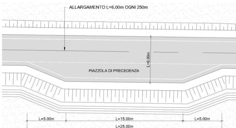
Figura 14.12 - Caratteristiche geometriche della piazzola di precedenza
