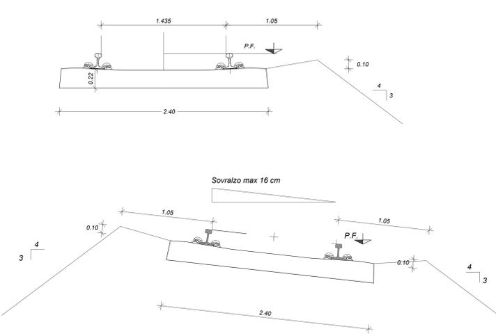
Sezione tipo a *singolo binario* in rilevato
