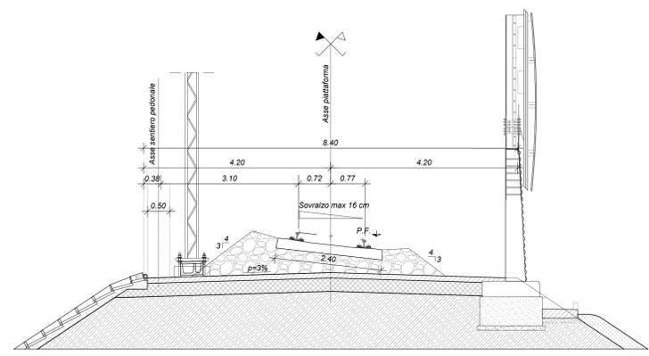
Dettaglio "1" - Andamento traversa in rettilo ed in curva
