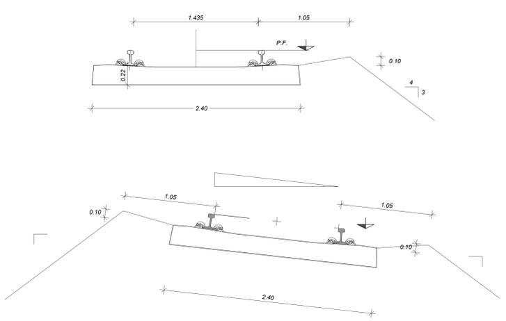
Sezione tipo a singolo binario in trincea
