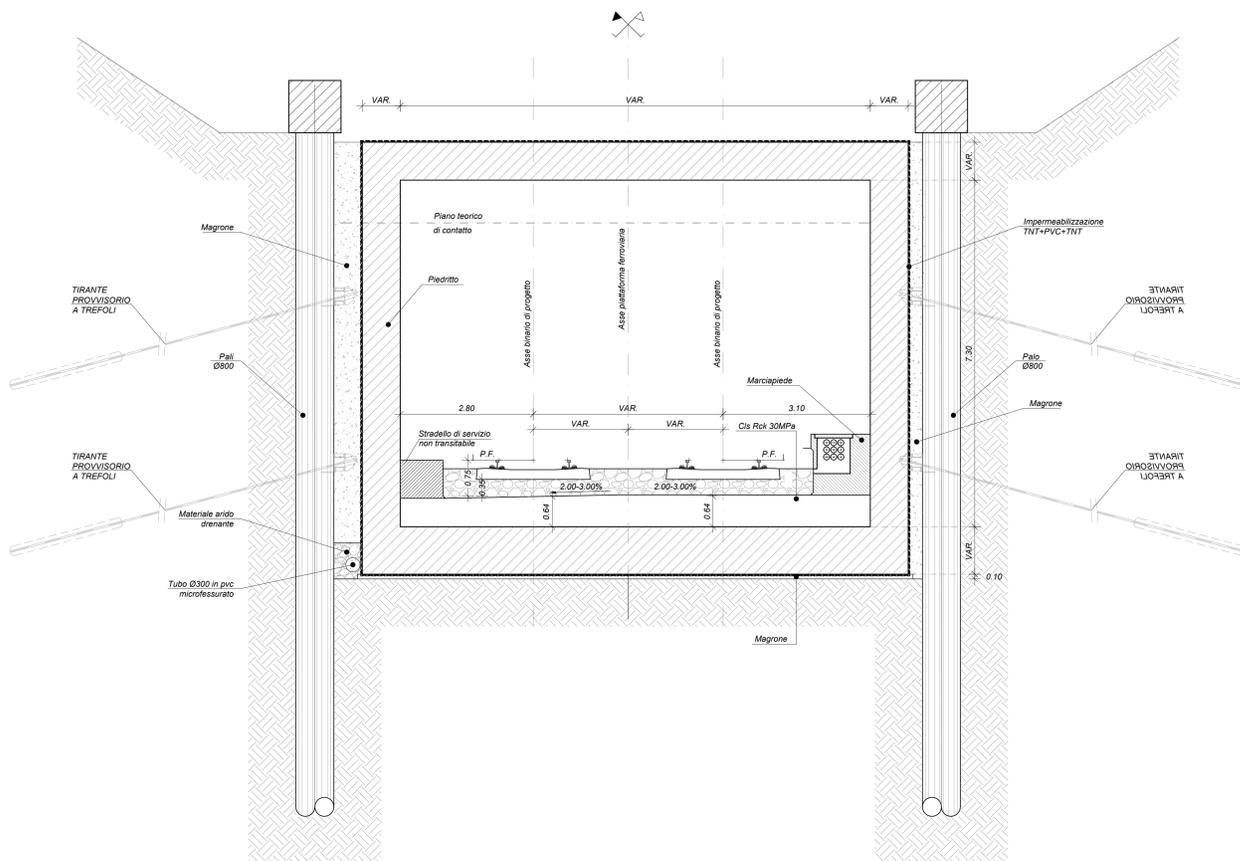
Pianta per sezione tipo a doppio binario in trincea con G.A.
