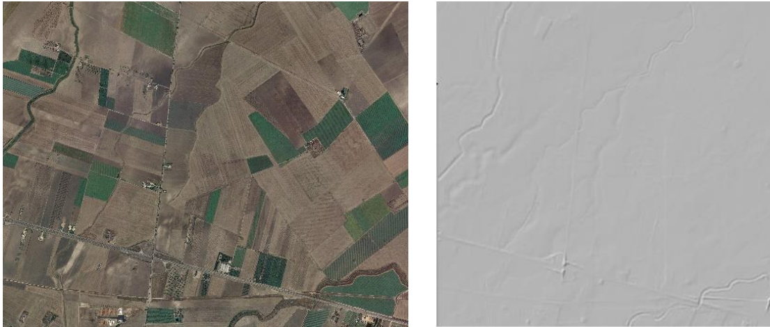
Figura 3-8: Rilievo fotogrammetrico – in ordine da sinistra sono riportati: ortofoto-DTM (Ombreggiature)
