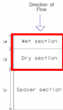
Figura 6-6: modulo tipo descrivente il modello concettuale idrologico dell'installazione di strutture fotovoltaiche a tracker su pari infissi comprendente l'area pannelli (in rosso) e l'area di interfila (Fonte: Hydrologic response of solar farm Cook 2013 American Society of Civil Engineers)
