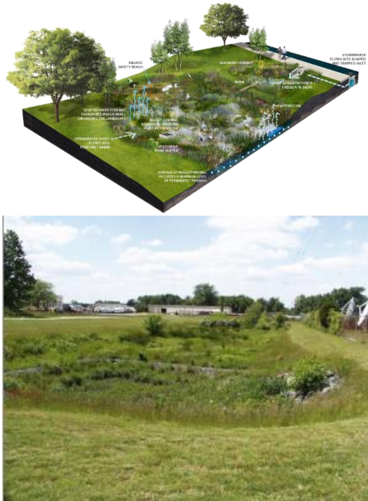
Figura 4-3: Tipologico bacino laminazione/infiltrazione rinverdito
