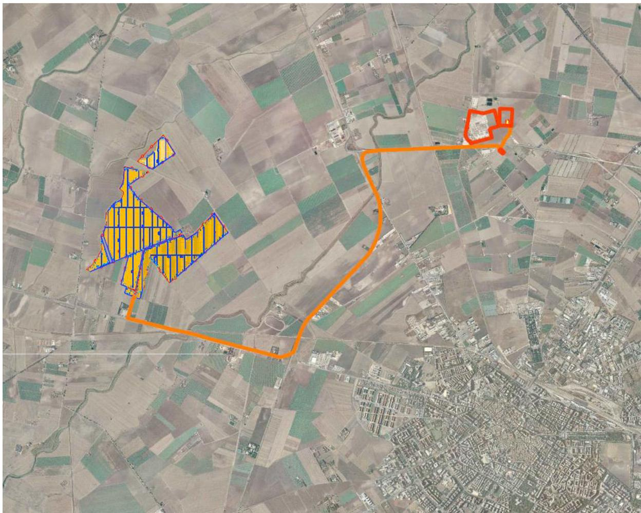
*Figura 1.1: Localizzazione dell'area di intervento, in giallo area contrattualizzata, in rosso recinzione dell'impianto, in arancio linea di connessione*
