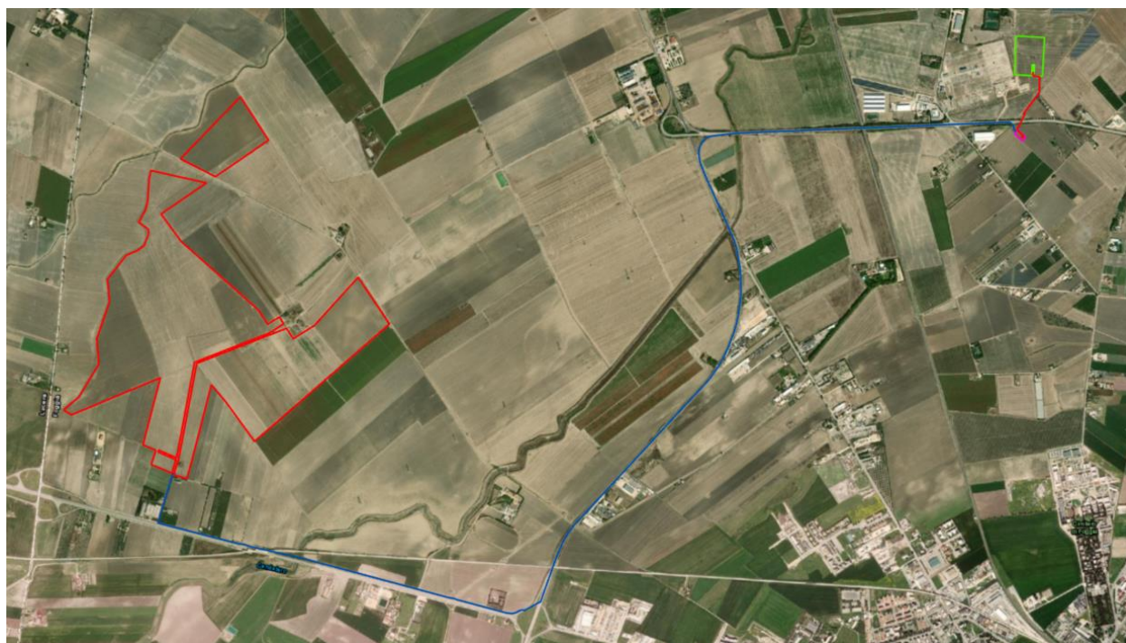
Figura 2.9: In blu il percorso di connessione dal campo FV alla Sottostazione AT 380/150 kV Foggia
