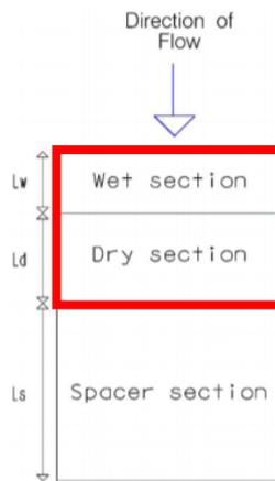
Figure 4-7: modulo tipo descrivente il modello concettuale idrologico dell'installazione di strutture fotovoltaiche a tracker su pari infissi comprendente l'area pannelli (in rosso) e l'area di interfila (Fonte: Hydrologic response of solar farm Cook 2013 American Society of Civil Engineers)
