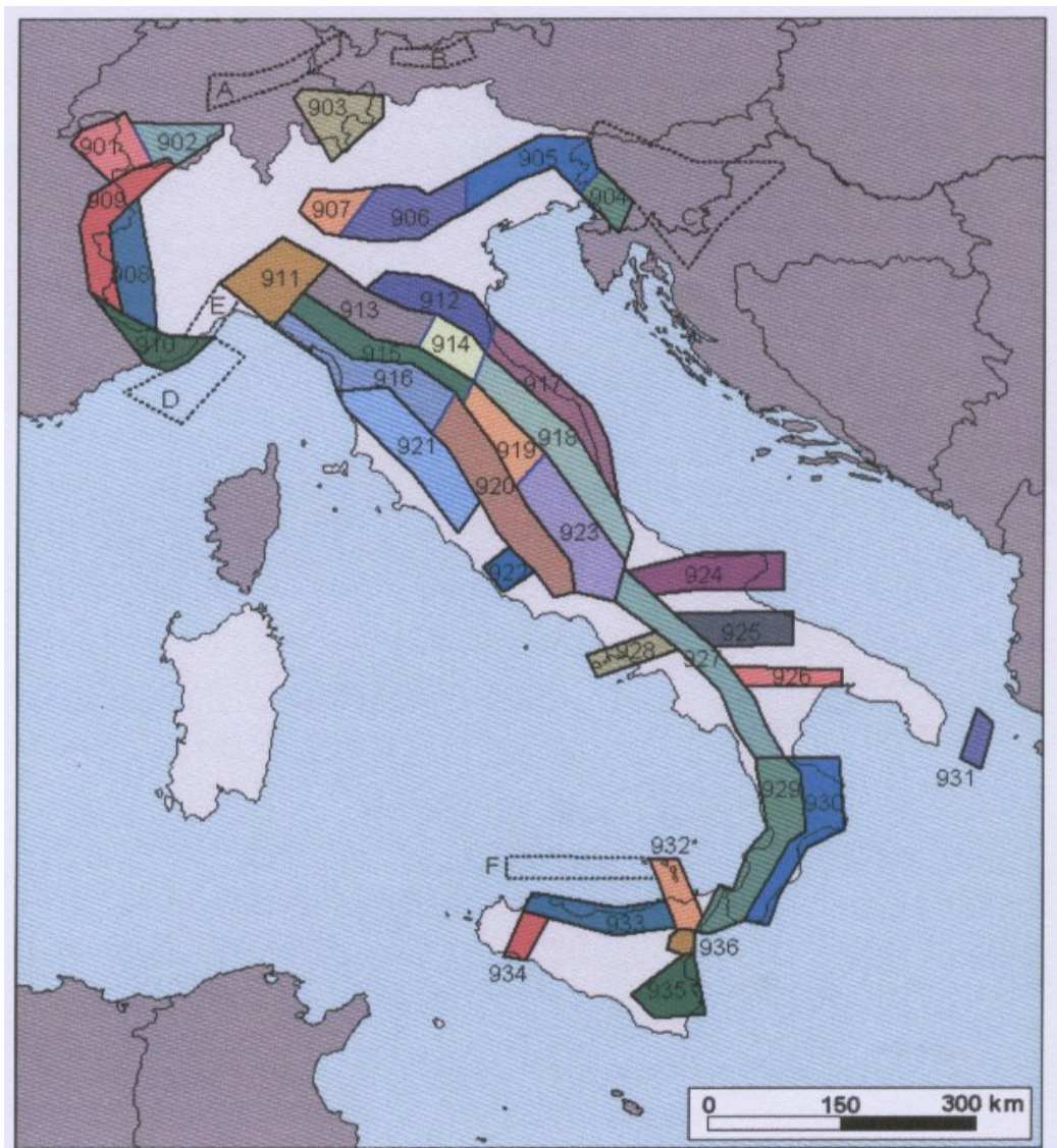
Fig. 6 – Zonazione sismogenetica ZS9. I limiti di colore blu separano zone con analogo significato cinematico, che differiscono principalmente per le caratteristiche di sismicità. Le ZS con bordo a tratteggio, identificate con una lettera, non sono utilizzate nella valutazione della pericolosità
