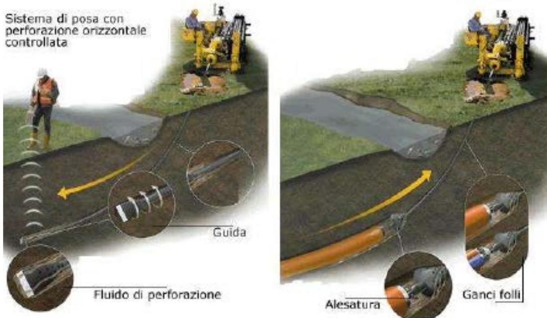
*Posa in opera tubazione con trivellazione teleguidata*
